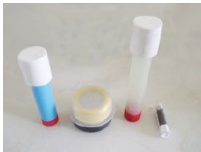
Figura 2: Dispositivos empleados en el muestreo pasivo de contaminantes gaseosos
