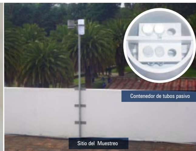
Figura 3: Detalle del dispositivo de muestreo pasivo
