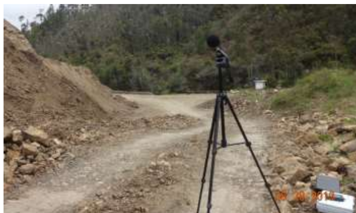
Se ha realizado medición de ruido
